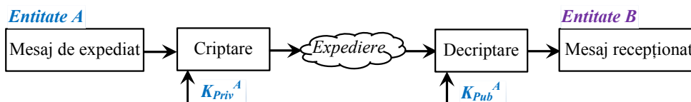
Figura 2. Autentificarea mesajelor utilizând metoda asimetrică de criptare
